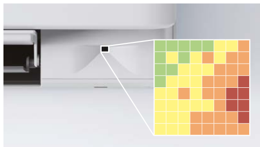
Der intelligente Thermo- und Bewegungssensor unterteilt die Raumoberfläche in 64 Quadrate, um ihre Temperatur genau zu bestimmen.
